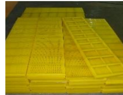
Panneau de crible 1200x300 en PUR 85 Sh A anti-abrasion
